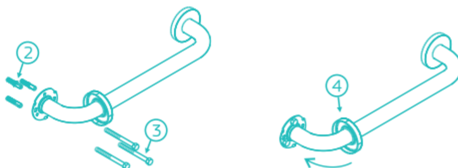
Posicionamentos buchas e parafusos (2 e 3) / Fixação canopla (4)
